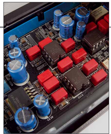
Edle AD-Chips im Keramikgehäuse: Sowa verbaut heute kaum noch jemand, hier sind sie sogar auswechselbar
